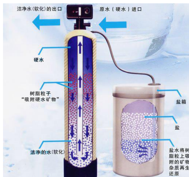
图 2-13 离子交换软水器工作及再生示意图
