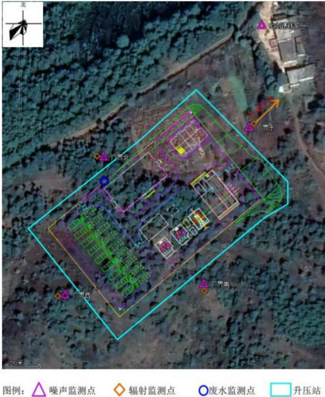
图 5-1 类比站站区总平面布置及监测点布置图
