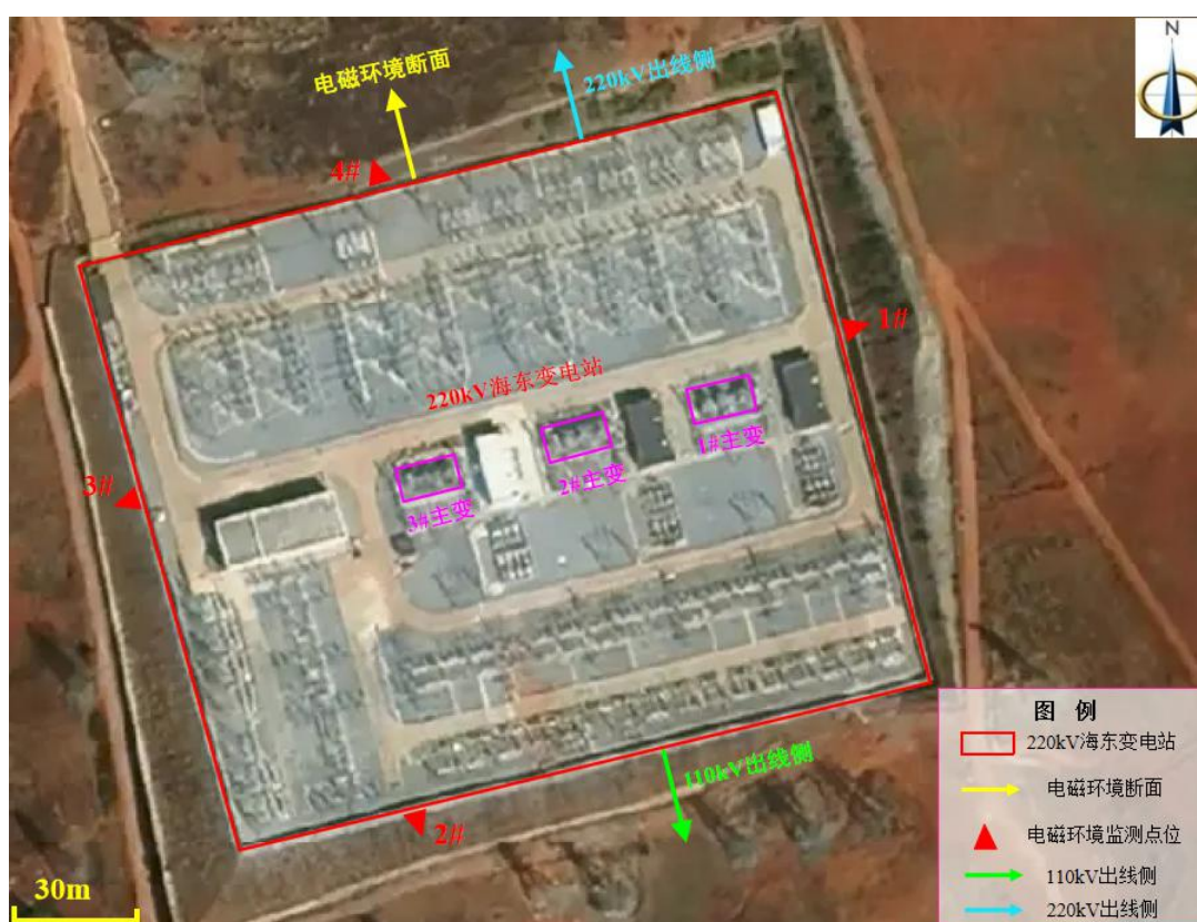
图2 220kV 海东变电站监测布点示意图
